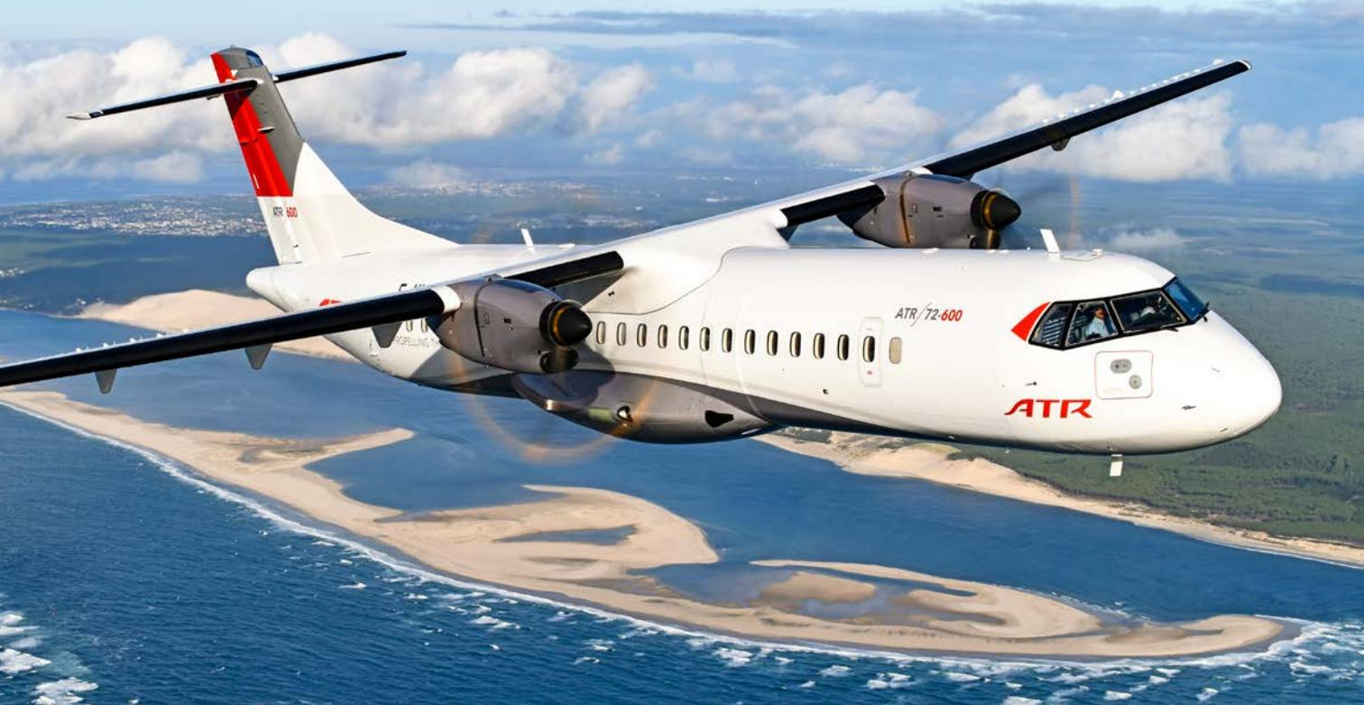
**Prototype ATR 72-600S.** L'appareil pourra atterrir sur des pistes de seulement 800 mètres. Une nouvelle solution pour desservir les îles.
