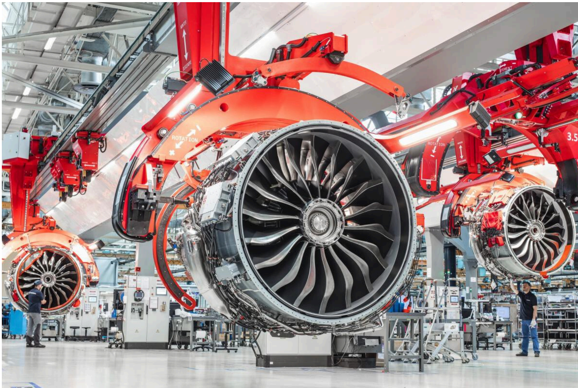
LEAP -1C, el motor occidental que utiliza el Comac C919 chino
